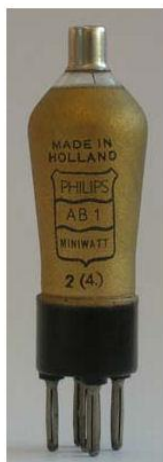
Abb. 1 Ansichten der Doppeldiode AB1 und GZ34 (Ersatztyp für 5Y3GT).
